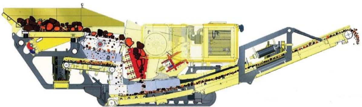
Figura 35: Schema di funzionamento dell'impianto mobile di frantumazione.
