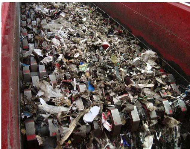
Esempi di vaglio a dischi - Superficie vagliante
