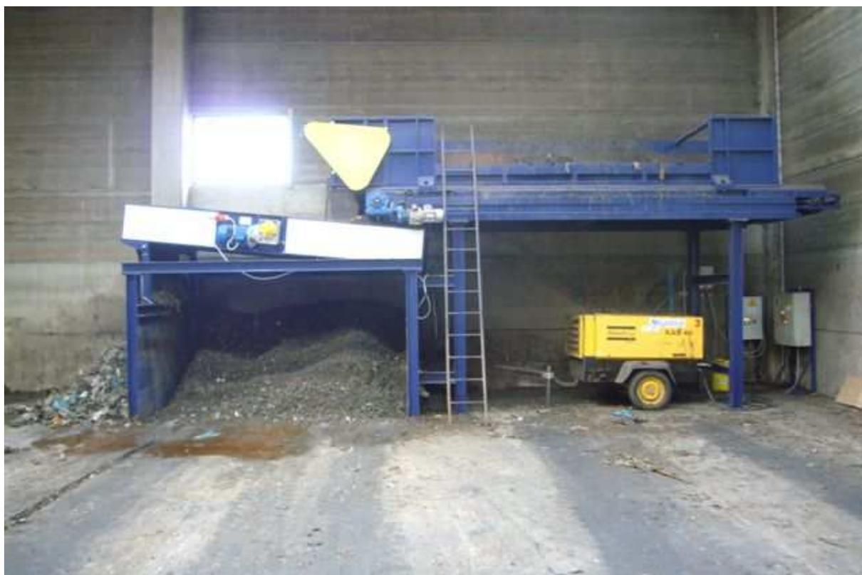
Vaglio a dischi – esempio di installazione
