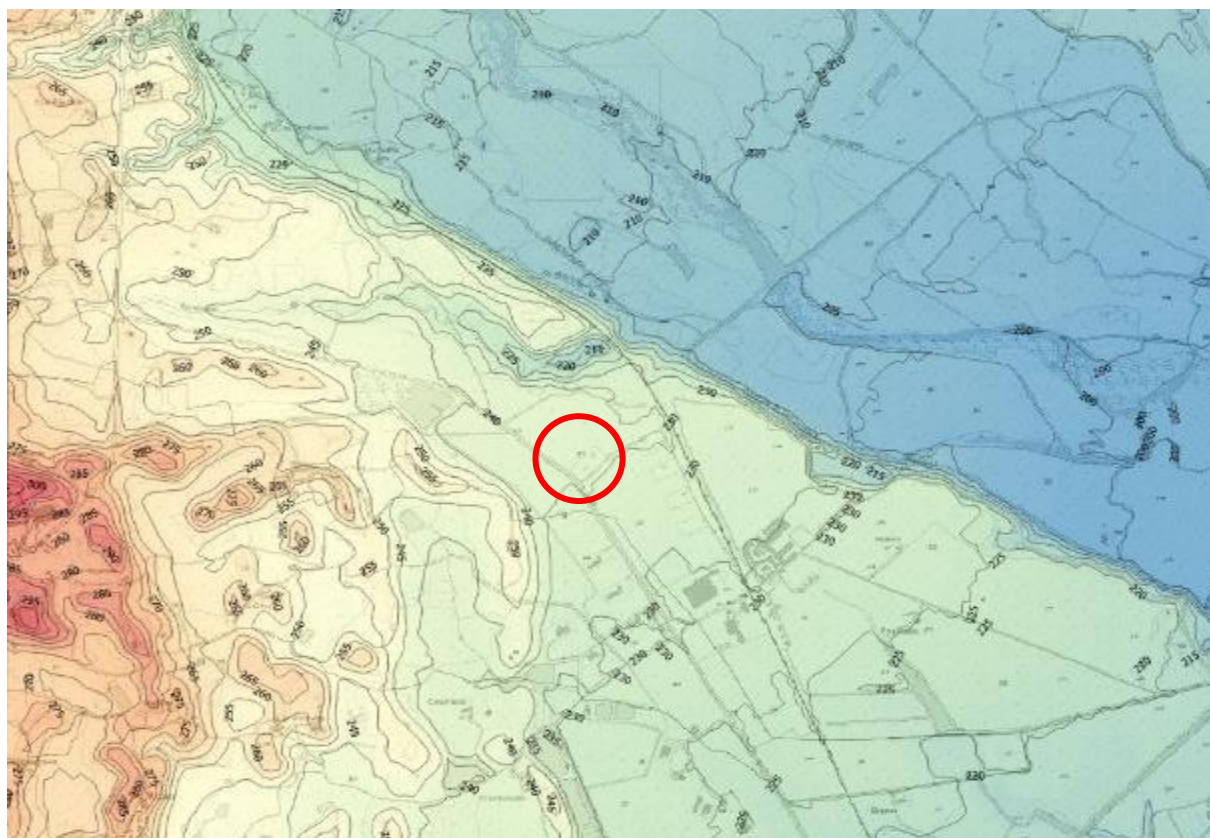
Figura 35 - Elaborazione DTM su base CTR – Altimetrie da Q.200 m a Q.300 m s.l.m.
