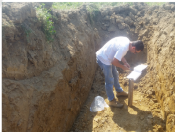
Figura 1: Attività di riempimento e sigillatura fustella
