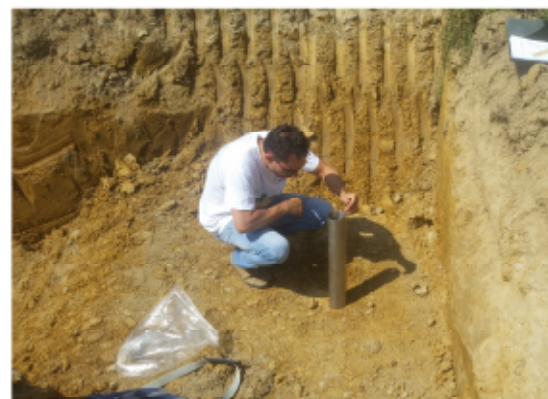
Figura 4: attività di misurazione del battente idraulico al termine della prova
