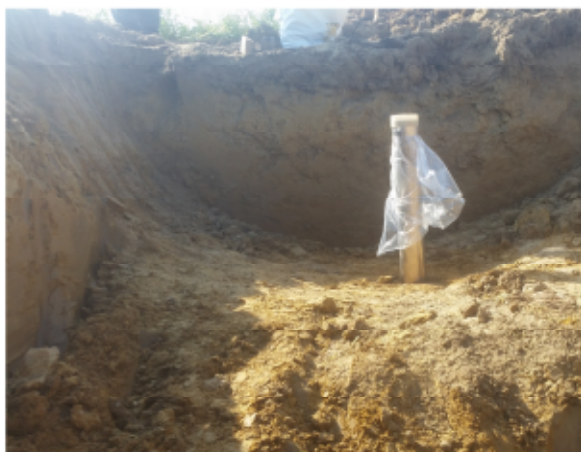
Figura 3: fustella infissa durante la prova a quota più superficiale
